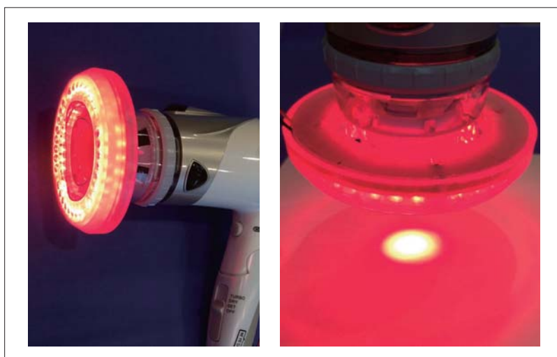
図1 市販のヘアードライヤーに高エネルギー密度赤色LEDユニットを組み込んだ実験機(LEDヘアードライヤー)
